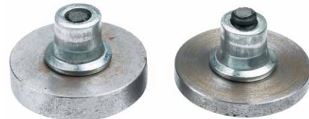
Remache Avbolt colocado sobre el máx. y mín. espesor, parte vista
